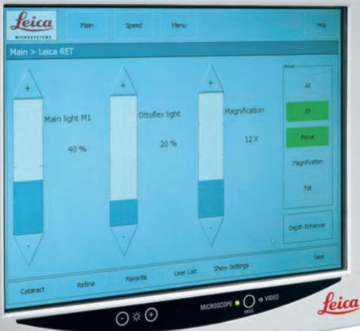
Unidad de control Leica con pantalla de doble función: modo control (arriba) y modo vídeo (abajo)
